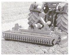
walze wie z.B. Zahnpackerwalze, Rohrstabwalze oder Scheibenpackerwalze an.
