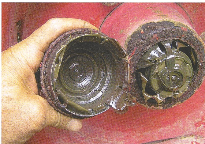
Hart gewordenes Fett in Radnaben muss durch neues ersetzt werden.
