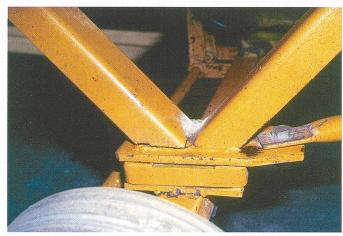
Schäden wie Risse und Verschleissstellen sind in der Regel nicht sofort zu erkennen. Erst die genaue Prüfung von Maschine und Bauteilen nach entsprechender Reinigung fördern sie zu Tage.
