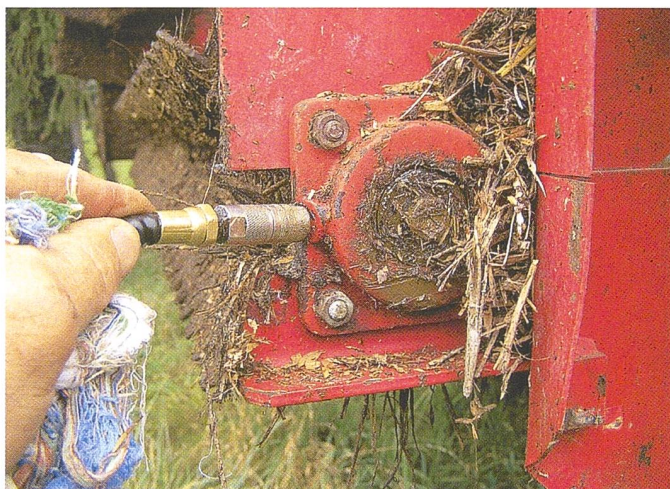
Lager vor dem Waschen schmieren, so kann Wasser weniger gut eindringen.
