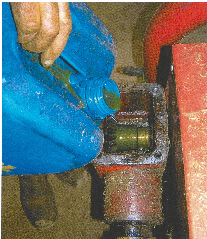
In «schwitzende» Winkelgetriebe kann an Stelle von Öl auch Getriebe- fliessfett eingefüllt werden.
