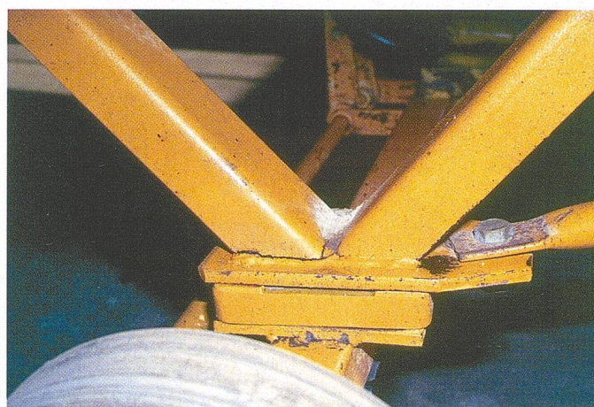
Schäden wie Risse und Verschleissstellen sind in der Regel nicht sofort zu erkennen. Erst die genaue Prüfung von Maschine und Bauteilen nach entsprechender Reinigung fördern sie zu Tage.
