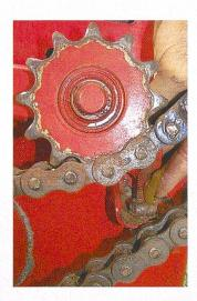
Gewinde von Spannschrauben durch Einfetten gegen Festrosten schützen.
