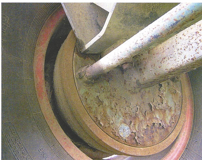
Ist die Bremshebelwelle im Bremsschild eingerostet, müssen die Bremsbeläge kontrolliert werden.
