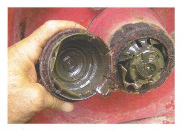
Hart gewordenes Fett in Radnaben muss durch neues ersetzt werden.
