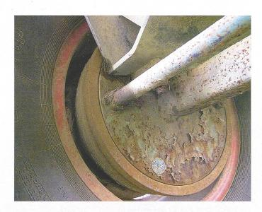
Ist die Bremshebelwelle im Bremsschild eingerostet, müssen die Bremsbeläge kontrolliert werden.
