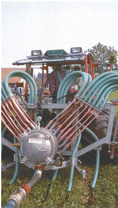
Gülle und Mist müssen auch im Berggebiet gezielt und umweltverträglich eingesetzt werden. Die meisten Schleppschlauchverteiler eignen sich heute auch für den Einsatz am Hang, wie eine Untersuchung von Agroscope FAT bestätigt.
