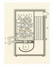
Sturzbrandkessel mit zweistufiger Verbrennung durch Vergasung des Holzes und anschliessende Gasverbrennung. 1: Primärluft, 2: Füllschacht, 3: Glutbett mit Vergasungszone, 4: Sekundärluft, 5: Nachbrennkammer, 6 Wärmeübertrager, 7: Abgas. Die in Bild 2 genannten Probleme können mit diesem Prinzip weitgehend vermieden werden.
