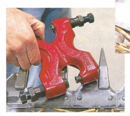
Klingenwechsel leicht gemacht: Niete herausdrücken, Klinge wechseln und mit dem gleichen Instrument wieder vernieten.
