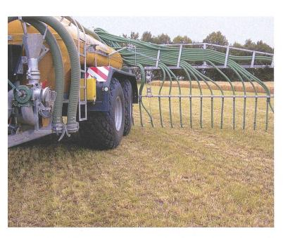
Mit dem Schleppschlauchverteiler lassen sich gegenüber Breitverteilern die Ammoniak-Emissionen um 30 bis 60% reduzieren. Ein Tandemfahrwerk mit gelenkter Achse schont die Grasnarbe (Bilder: Agroscope FAT).
