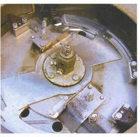
Schneidwerk im Verteilerkopf, unabdingbar zur Verhinderung von Verstopfungen.
