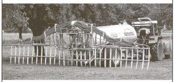
Der neue EXA-CUT-Verteilerkopf funktioniert an jedem Vakuumfass. Gülle mit hohem Strohanteil wird verstopfungsfrei ohne zusätzliches Schneidwerk ausgebracht.
