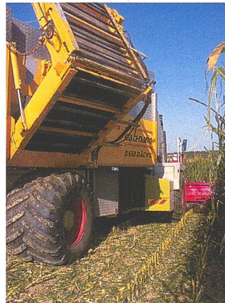
«Power Mais»-Häcksler: Deutlich erkennbar ist der Mulch jener Maisreihen, in denen nur der Kolben gepflückt wird.
