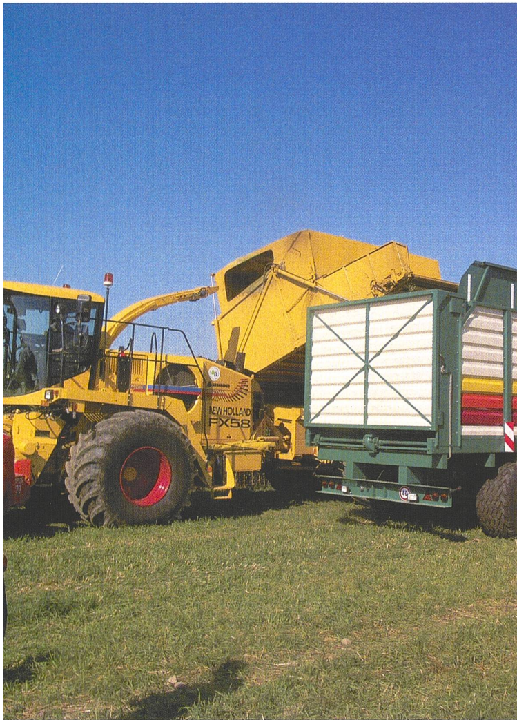
«Power Mais»-Häcksler: Deutlich erkennbar ist der Mulch jener Maisreihen, in denen nur der Kolben gepflückt wird.
