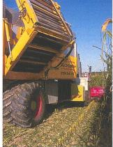
«Power Mais»-Häcksler: Deutlich erkennbar ist der Mulch jener Maisreihen, in denen nur der Kolben gepflückt wird.
