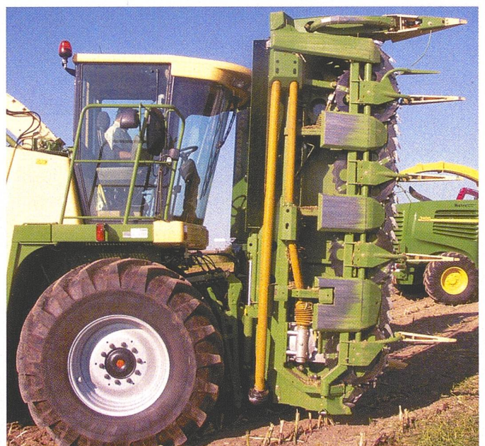
Maisgebiss von BigX-Feldhäcksler von Krone. Eine hydraulische Absenkung drückt die Gesamthöhe unter die geforderten 4 Meter.
