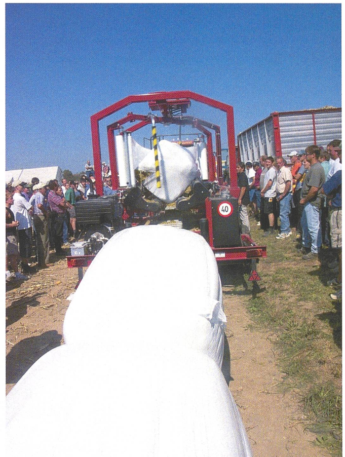
Kombiniertes Verfahren zum Wickeln von Viereckmaiballen. Und trotzdem gibt der Lohnunternehmer Andreas Wiesendanger mit auf den Weg, für grosse Mengen das kostengünstigere Silierverfahren der «Silowurst» zu wählen und zum Beispiel nur für die Sommerfütterung auf Siloballen auszuweichen.
