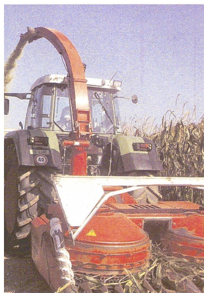
Anbaumaishäcksler Kemper (Ruedi Kröni, Wilen b. Neunforn) vierreihig nach wie vor eine gute Option. Er trägt zur guten Auslastung der starken Traktormotorisierung bei.
