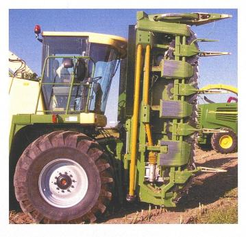
Maisgebiss von BigX-Feldhäcksler von Krone. Eine hydraulische Absenkung drückt die Gesamthöhe unter die geforderten 4 Meter.
