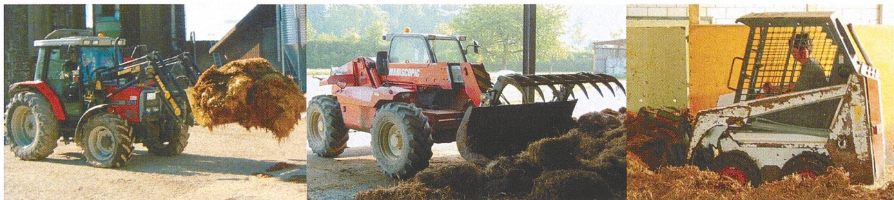
Abb. 10: Entsprechend den betriebsspezifischen Gegebenheiten werden bei der mobilen Entmistung von Tiefstreuställen unterschiedliche Verfahren eingesetzt.
