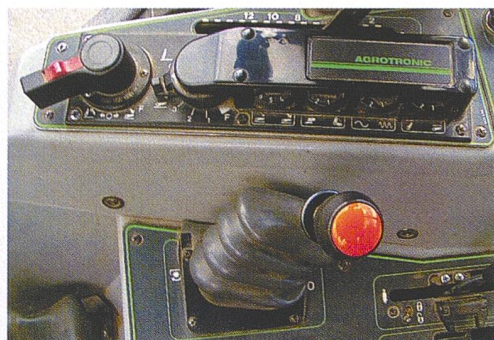
Einfache Bedienung und kompakte Anordnung zeichnen diese Konstruktion der EHR-Bedienelemente aus. (Bild R. Hunger)
