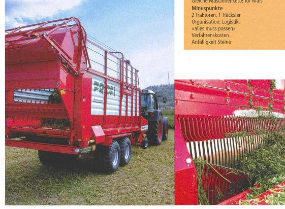
Die Stärke des Förderrotors: hohe Förderleistung und exakter Kurzschnitt auf ca. 4 cm.
