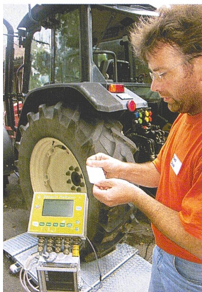
Elektronikanwendung «Rasche Gewichtsmessung»: Aus dem Befahren der Waage mit dem Anhängerzug wird vor und nach dem Entladen aus den Achslasten das Gewicht des Ladegutes ermittelt.
