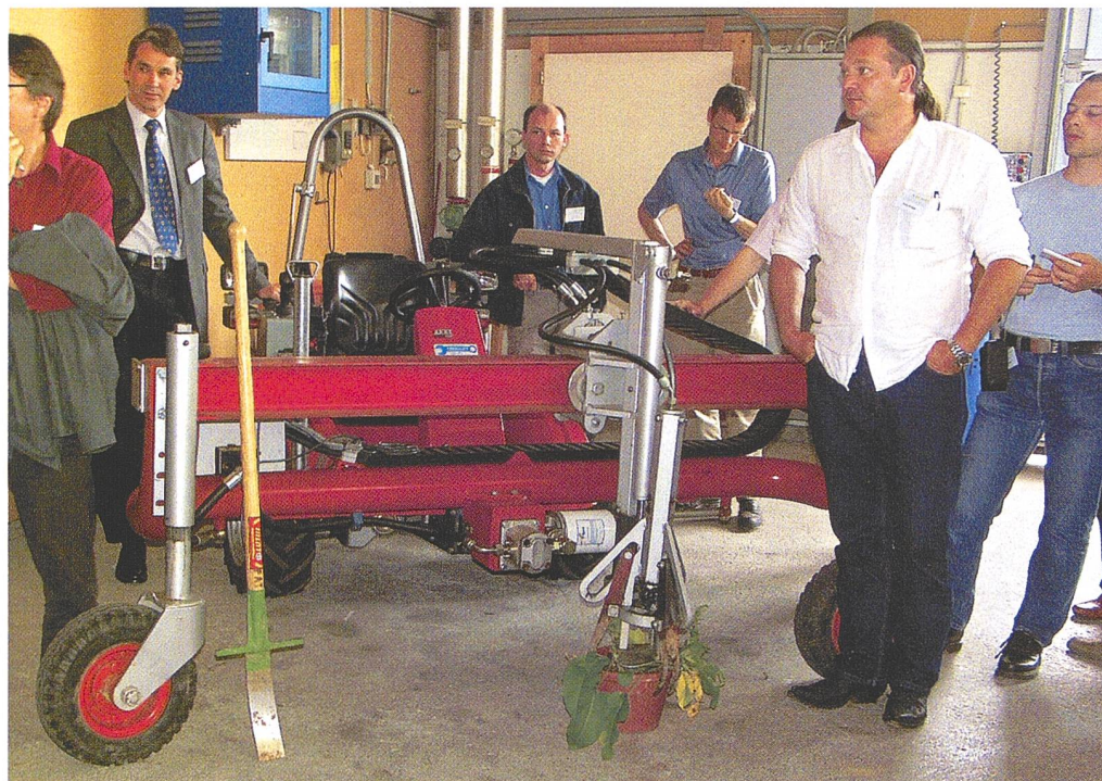
Elektronikanwendung «Mechanische Blackenbekämpfung»: Der Prozessor unterscheidet vergleichend mit dem Bild der Digi-Cam Blacken vom übrigen Pflanzenbestand und lenkt das Ausstechgerät auf einer Schiene an die richtige Position.
