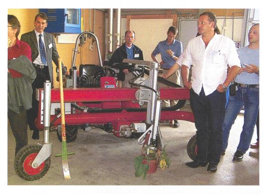
Elektronikanwendung «Mechanische Blackenbekämpfung»: Der Prozessor unterscheidet vergleichend mit dem Bild der Digi-Cam Blacken vom übrigen Pflanzenbestand und lenkt das Ausstechgerät auf einer Schiene an die richtige Position.
