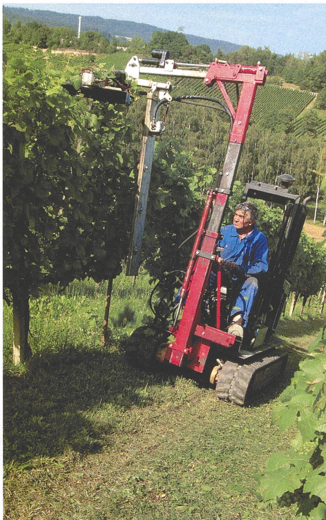
Die von Loeffel in Boudry hergestellten Raupenträger Viti-Plus haben eine ausgezeichnete Manövrierbarkeit. Das abgebildete Gerät hat trotz den geringen Abmessungen eine Motorleistung von nahezu 80 PS. Die Hydraulik ermöglicht eine sanfte Fahrweise der Raupen und ein ruckloses Funktionieren der Anbaugeräte. Der Viti-Plus hat zudem einen Wendesitz.
