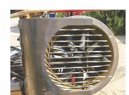
Eine herkömmliche Entlaubungsmaschine Ero eines deutschen Herstellers. Das Gebläse saugt die Rebblätter an und zerkleinert sie. Der Gitterschutz schont die Trauben und das Holz der Rebstöcke. Avidor bietet ein Gerät mit einem mobilen Tastband an, welches die Maschine noch präziser steuert.
