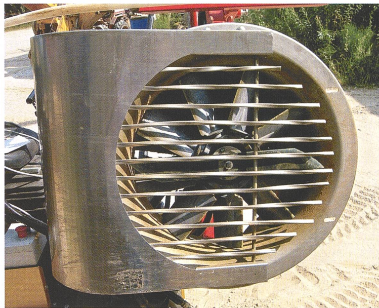
Eine herkömmliche Entlaubungsmaschine Ero eines deutschen Herstellers. Das Gebläse saugt die Rebblätter an und zerkleinert sie. Der Gitterschutz schont die Trauben und das Holz der Rebstöcke. Avidor bietet ein Gerät mit einem mobilen Tastband an, welches die Maschine noch präziser steuert.
