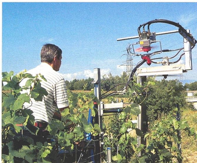
Geräteprototyp mit Mikronisationsbehandlung: Nur die obersten Blätter der Reben werden mit grosser Wirkung und geringen Mittelverlusten behandelt. Diese Technik ist für systemische Präparate, die in die Pflanzen eindringen, bestimmt.
