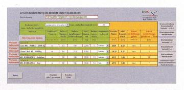
Abb. 2: Eingabemaske. Bis vier Varianten lassen sich gleichzeitig bearbeiten bzw. vergleichen. Die Reifendaten können entweder aus der Reifentabelle übernommen werden oder aber direkt in Zentimetern eingegeben werden.
