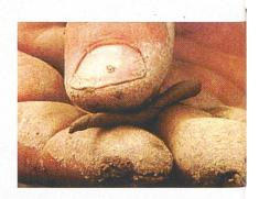
Abb. 3: Mittels der Fingerprobe können direkt im Feld Rückschlüsse auf die Körnung bzw. die Bodenart und die Bodenfeuchtigkeit gezogen werden.
