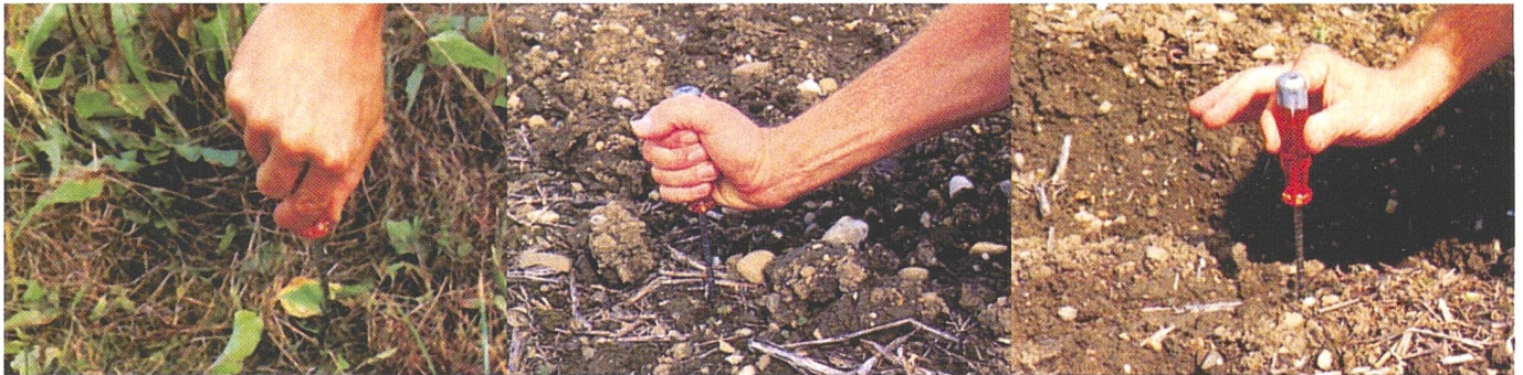
Abb. 4: Schraubenziehertest zur einfachen Bestimmung der Oberbodenfestigkeit: a) fest (>8 kg Druck), b) halbfest (5–8 kg Druck), c) weich (bis 5 kg Druck). Fotos: M. Welter.
