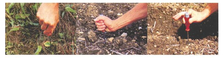
Abb. 4: Schraubenziehertest zur einfachen Bestimmung der Oberbodenfestigkeit: a) fest (>8 kg Druck), b) halbfest (5–8 kg Druck), c) weich (bis 5 kg Druck). Fotos: M. Welter.
