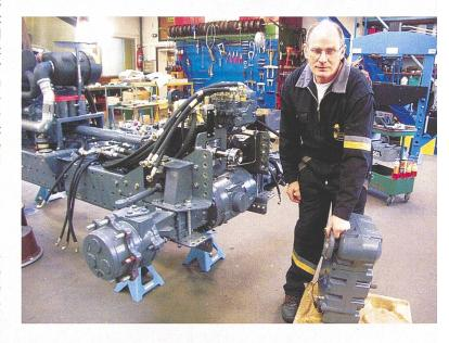
Endmontage des zweiten Traktors. Sepp Knüsel bringt die Eigenentwicklung des Heckgetriebes in die richtige Position. Deutlich erkennbar ist das in der Mitte verwindungsfähige Chassis. (Bild: U. Zweifel)
