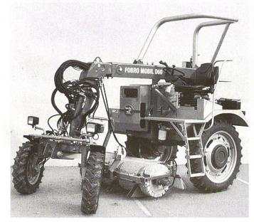
Das neue Diesel-Fobro-Mobil D60 4x4 mit ausziehbarem Rahmen
