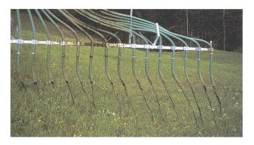
Schleppschlauchverteiler lassen sich auch in mässigen bis mittleren Hanglagen einsetzen, sofern das Gelände nicht zu stark coupiert ist. Die Arbeitsbreite sollte maximal 9 m betragen.
