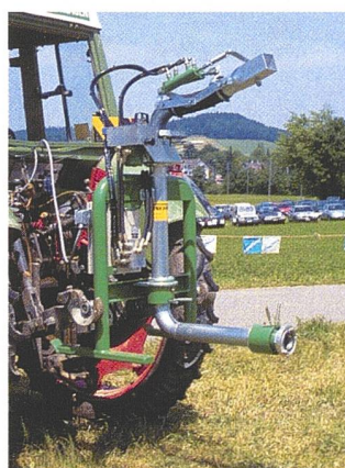
Fast alle Verteilautomaten können mit wenigen Handgriffen vom Traktor aus auf Handbedienung umgestellt werden.
