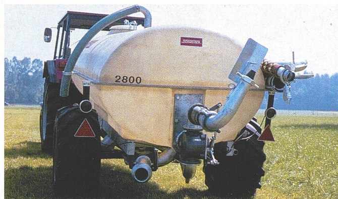
Soweit die Wurfweite reicht, kann nicht befahrbares Gelände am Hang auch mit dem Pumpfass begüllt werden.
