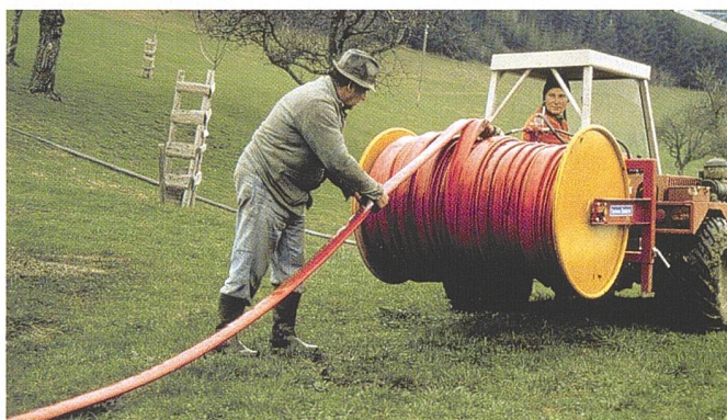
Die Schlauchhaspel ermöglichen eine rationelle und saubere Arbeit und weisen eine recht gute Kippsicherheit auf.
