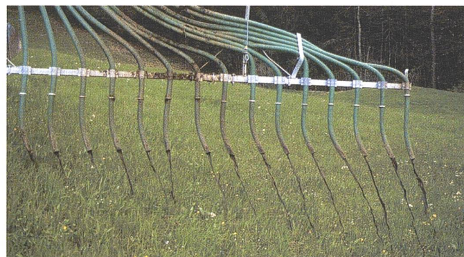
Schleppschlauchverteiler lassen sich auch in mässigen bis mittleren Hanglagen einsetzen, sofern das Gelände nicht zu stark coupiert ist. Die Arbeitsbreite sollte maximal 9 m betragen.
