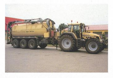
Das Wechselfahrwerk kann mit verschiedenen Aufbauten für die Silageernte und für das Gülleausbringen genutzt werden.
