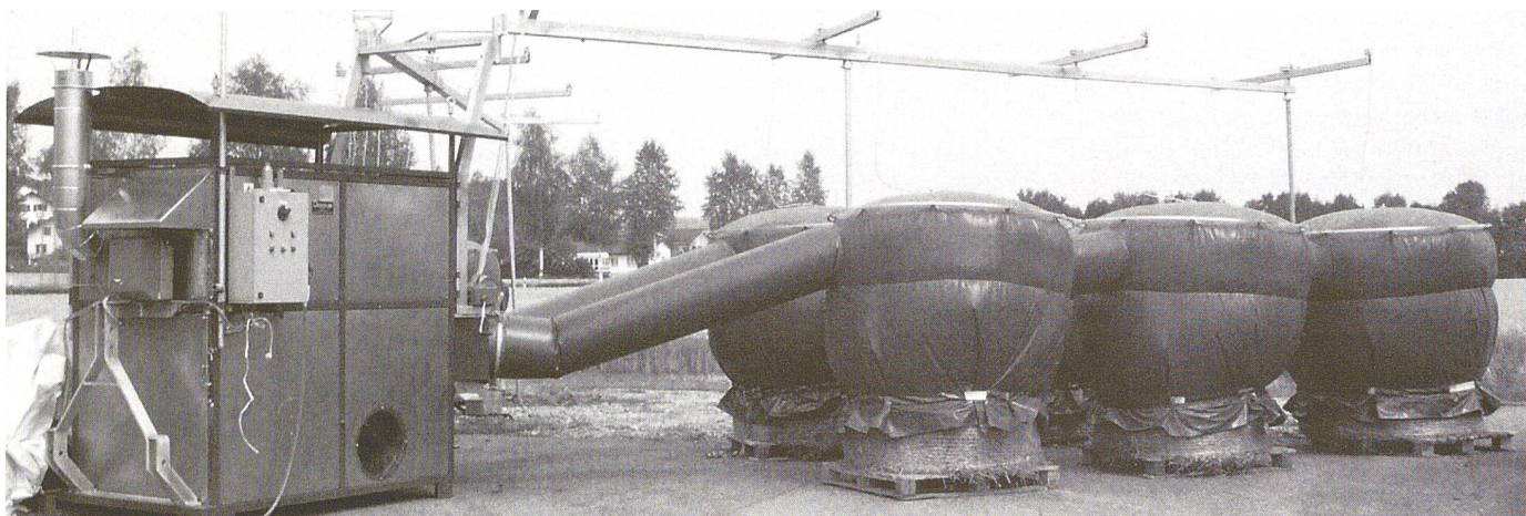
Abb. 4: Belüftungssystem Tecnomat: Obenbelüftung mit Hauben und Luftaustritt an unterer Stirnseite.
