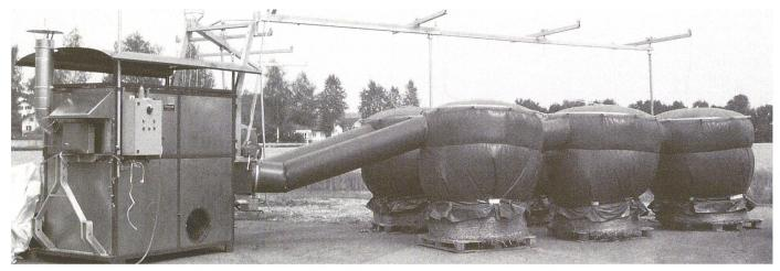
Abb. 4: Belüftungssystem Tecnolam: Obenbelüftung mit Hauben und Luftaustritt an unterer Stirnseite.
