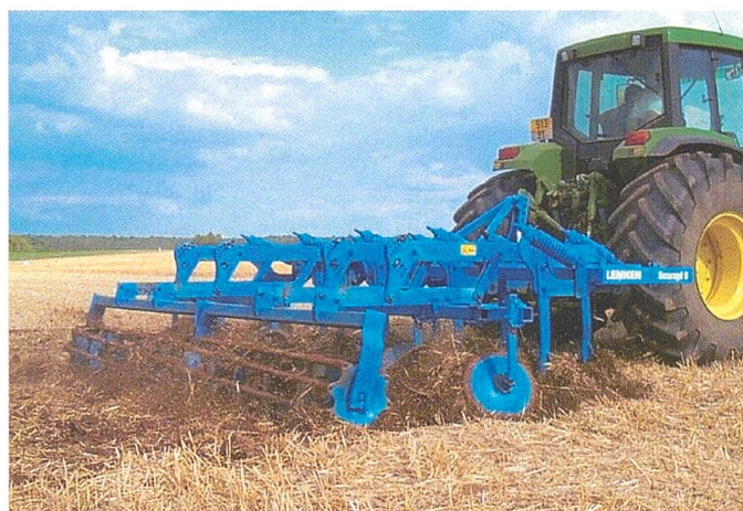
Grubber sind kostengünstig. Nur Gänsefusschare eignen sich für eine flache Bearbeitung.
