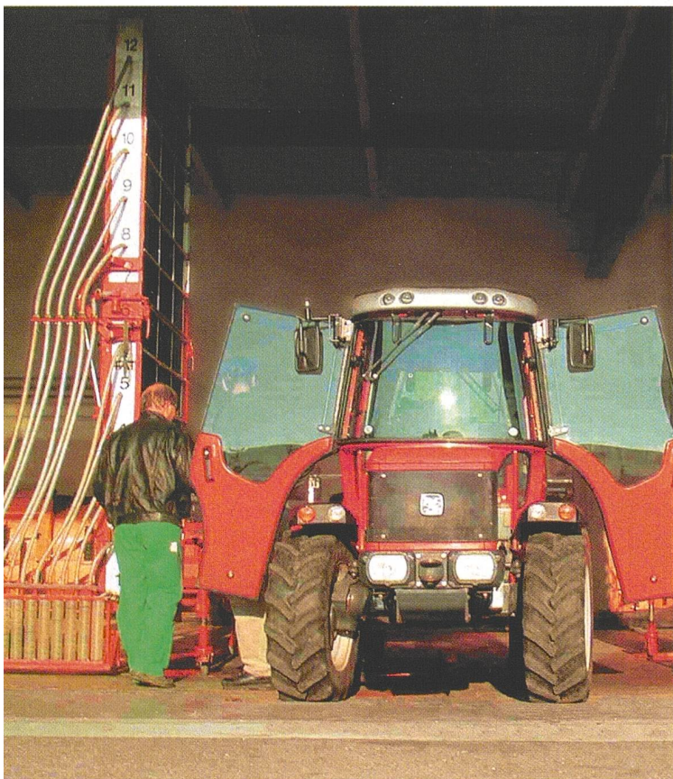
Sprühgerätetest: Messung der vertikalen Wasserverteilung mit zwei FAT-Lamellenprüfständen (Foto von Markus Bünter).
