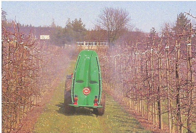
Applikation mit ID-Düsen beim Austrieb mit geringer Sprühnebelbildung.
