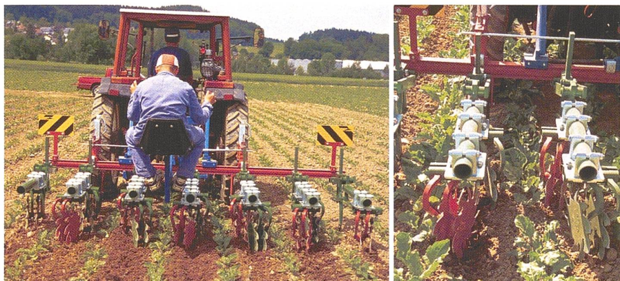
Abb.2: Durch das Sternhackgerät mit Lockerungsscharen wurde der Boden gut gelockert, gewendet und die Unkräuter durch Anhäufeln stark unterdrückt (2. und 3. Durchgang).
