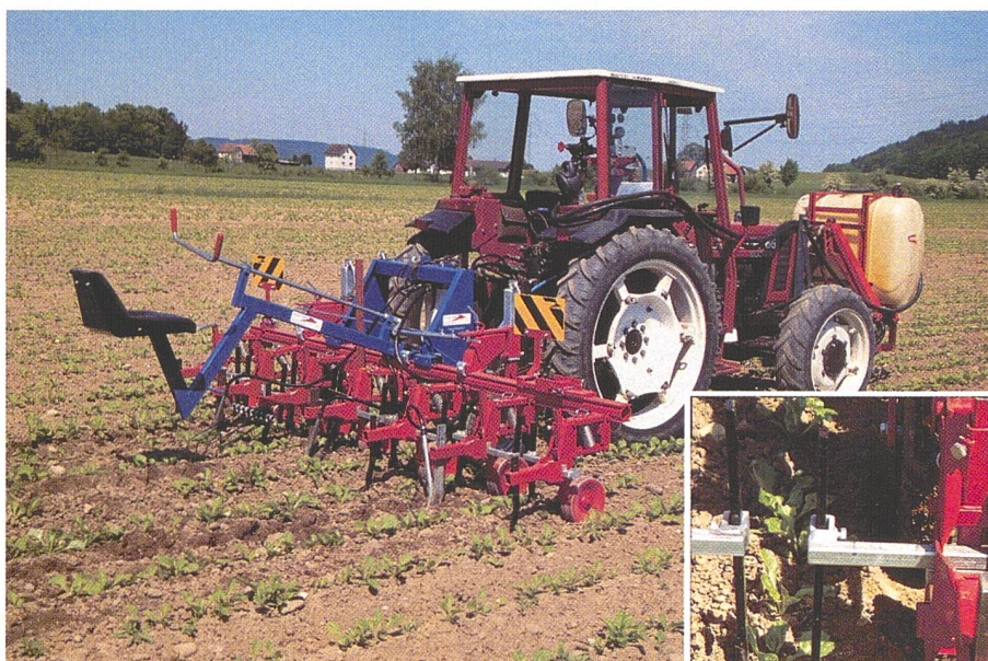
Abb.6: Bei der CULTAN-Düngung wird die konzentrierte Gülle von einer leistungsfähigen Pumpe über Leitung, Armatur und Schläuchen zu den drei Lockerungsmeisseln geleitet und 15 cm tief zwischen den Rübenreihen abgelegt.
