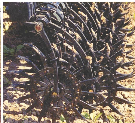
Abb. 3: Mit der Amerikanischen Sternhacke lässt sich eine ganzflächige Unkrautregulierung erreichen, ohne die Rüben stark zu schädigen (4-Blattstadium, schräger Anbau).
