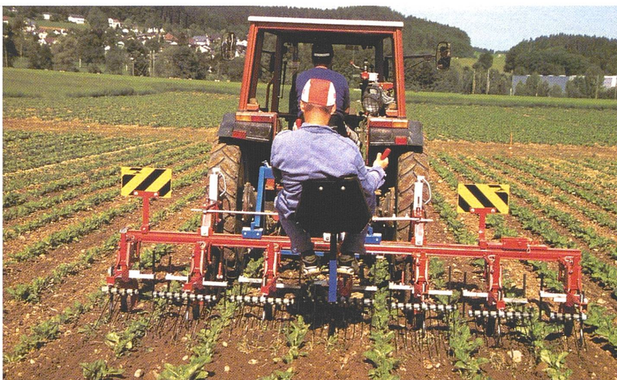
Abb. 1: Mit dreimaligen Einsätzen des Scharhackgerätes wurde eine ausreichende Unkrautregulierung zwischen den Reihen erzielt. Die angebauten Striegel verbessern den Arbeitseffekt wesentlich.
