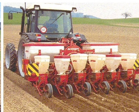
Abb. 4: Mit Kreiselegge mit Dammformblech aus dem Gemüsebau resultierten zu lockere und für die Saat zu wenig tragfähige Dämme. Andruckrollen und eine leichte mechanische Einzelkornsämaschine sind zu bevorzugen.
