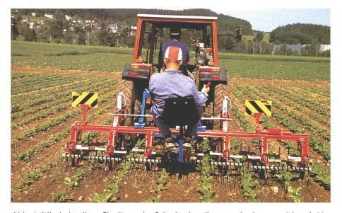
Abb. 1: Mit dreimaligen Einsätzen des Scharhackgerätes wurde eine ausreichende Unkrautregulierung zwischen den Reihen erzielt. Die angebauten Striegel verbessern den Arbeitseffekt wesentlich.
