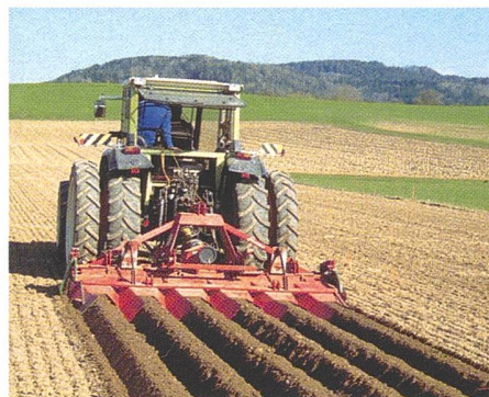
Abb. 4: Mit Kreiselegge mit Dammformblech aus dem Gemüsebau resultierten zu lockere und für die Saat zu wenig tragfähige Dämme. Andruckrollen und eine leichte mechanische Einzelkornsämaschine sind zu bevorzugen.
