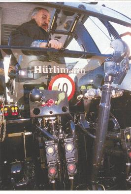
Konstantleistung. Zehn Gänge liegen im Hauptarbeitsbereich zwischen 4 und 15 km/h. Eine Schwingungsdämpfung reduziert die Lastspitzen beim Betätigen der Lastschaltstufen. Für die elektronische Regelung und Steuerung der Differenzialsperre vorne und hinten ist das Antriebssteuerungsmanagement ASM verantwortlich. Dieses schaltet auch den Allrad je nach Fahrgeschwindigkeit, Lenkeinschlag und Bremspedalstellung zu oder ab.
