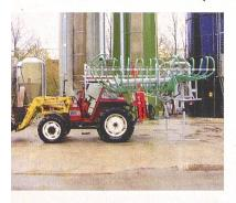
Arbeitsbreite: 9,0 m Anzahl der Abgänge: 36 Funktionsprinzip: Schneckenverteiler
