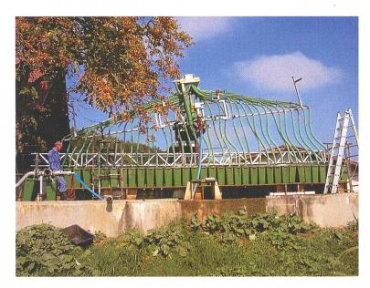
Abb. 1: Simulation des Gülleeinsatzes bei 30% Hangneigung
