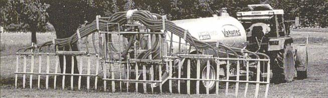
Der neue EXA-CUT-Verteilerkopf funktioniert an jedem Vakuumfass. Gülle mit hohem Strohanteil wird verstopfungsfrei ohne zusätzliches Schneidwerk ausgebacht.
