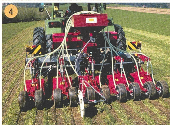
4: Streifenfrässaat: Die über die Zapfwelle angetriebenen Fräsaggregatete bearbeiten den Boden in einer Tiefe von zirka 4 bis 6 cm. Das aufgebaute pneumatische Sägerät bläst das Saatgut über die Säschläuche in die zirka 12 cm breiten Streifen. Die nachlaufenden Gummiräder drücken den Samen an. Rund zwei Drittel der Vegetationsdecke bleiben unbearbeitet.
