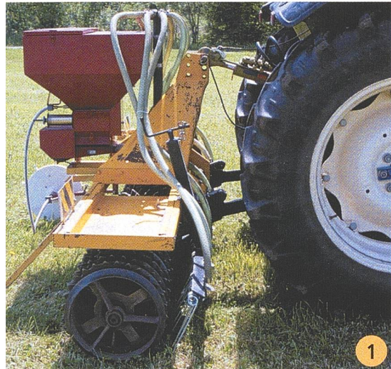
2: Sättriegel: Der Vertikator von Hatzenbichler besteht aus einem über ein Parallelogramm geführten Striegel mit fünf Zinkenreihen, einem aufgebauten pneumatischen Sägerät und einer dreiteiligen Nachlauf-Gummiwalze. Ein randverzahntes Planierschild ebnet Kuhfladen, Mistreste und Mäusehaufen ein.
