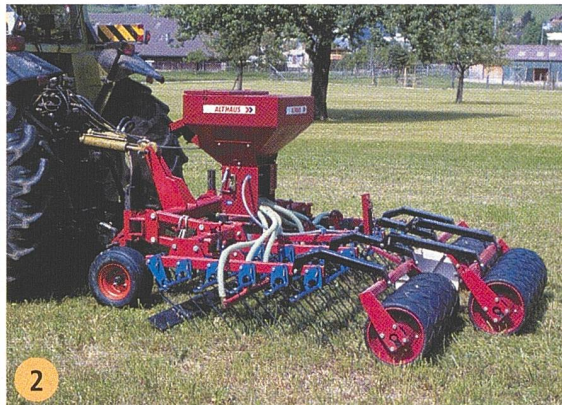
2: Sättriegel: Der Vertikator von Hatzenbichler besteht aus einem über ein Parallelogramm geführten Striegel mit fünf Zinkenreihen, einem aufgebauten pneumatischen Sägerät und einer dreiteiligen Nachlauf-Gummiwalze. Ein randverzahntes Planierschild ebnet Kuhfladen, Mistreste und Mäusehaufen ein.
