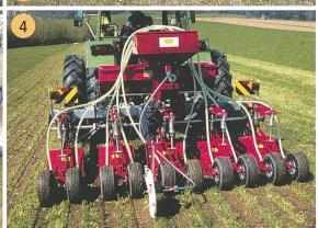
4: Streifenfrässaat: Die über die Zapfwelle angetriebenen Fräsaggregate bearbeiten den Boden in einer Tiefe von zirka 4 bis 6 cm. Das aufgebaute pneumatische Sägerät bläst das Saatgut über die Säschläuche in die zirka 12 cm breiten Streifen. Die nachlaufenden Gummiräder drücken den Samen an. Rund zwei Drittel der Vegetationsdecke bleiben unbearbeitet.
