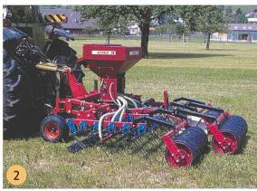
3: Drillsaat: Die speziellen Schlitzmesser der Drillsämaschine Köckerling Herbamat ziehen in Abständen von 8 cm zirka 1 cm breite Rillen in den Boden. Der mechanische Amazone-Säkasten befördert das Saatgut über die Särohre in die zirka 2 cm tiefen Schlitze. Gefederte Rundbügel drücken den Samen an und sorgen für den nötigen Bodenkontakt.
