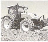
Ecotronic-Spargetriebevariante mit elektronischer Reduktion auf 40 km/h lieferbar. Diverse Managementfunktionen für Allrad, Differenzial, Zapfwelle sowie das Easy-Tronic-Vorgewende-Management erleichtern die Arbeit des Fahrers. Die Hochleistungs-Hydraulikanlage mit variabler Förderleistung bis 113 l/min und vier elektronischen Proportionalventilen lässt keine Wünsche offen.
