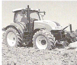
Ecotronic-Spargetriebevariante mit elektronischer Reduktion auf 40 km/h lieferbar. Diverse Managementfunktionen für Allrad, Differenzial, Zapfwelle sowie das Easy-Tronic-Vorgewende-Management erleichtern die Arbeit des Fahrers. Die Hochleistungs-Hydraulikanlage mit variabler Förderleistung bis 113 l/min und vier elektronischen Proportionalventilen lässt keine Wünsche offen.
