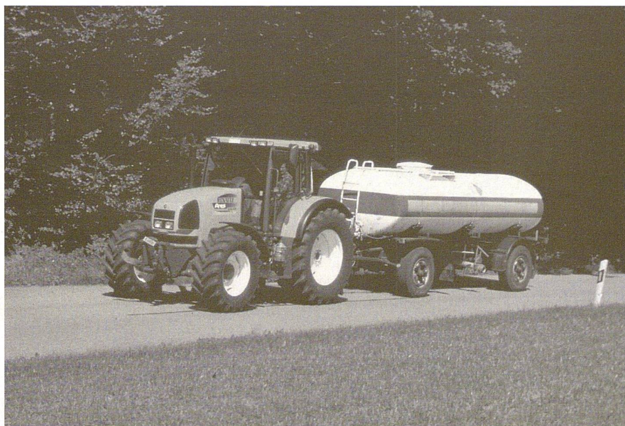
Abb. 1: Ein Tankwagen mit einem Bruttogewicht von 15 000 kg und einem Leergewicht von 3200 kg dient als Anhängelast.
