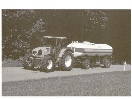
Abb. 1: Ein Tankwagen mit einem Bruttogewicht von 15 000 kg und einem Leergewicht von 3200 kg dient als Anhängelast.
