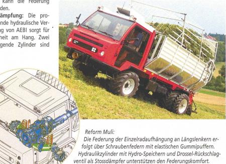
Für den Arbeitseinsatz im Gelände gibt es eine hydraulische Federsperre (bei 565/575S serienmässig, 8er-Serie auf Wunsch). (Werksfoto)
