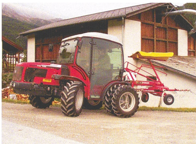
Wendetraktoren (hier Ergit TTR 7400 von A. Carraro) sind in mässig steilem Gelände eine interessante Alternative zum Zweiaxsmäher mit vielfältigen Einsatzmöglichkeiten nicht nur in der Futterwerbung. Bild: Abfahrt zur Arbeit in Santa Maria.
