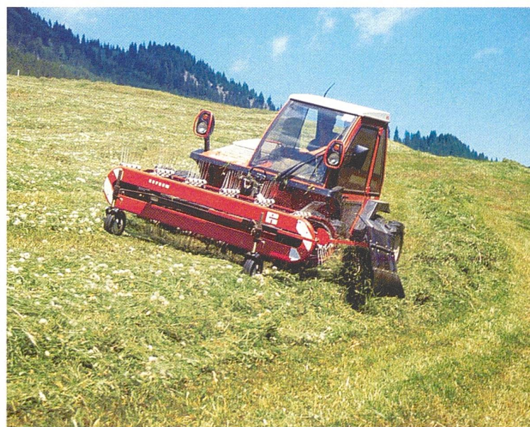
Die heutigen Zweiaxsmäher (hier Reform Metrac H7) erledigen die erforderlichen Einsätze für die Futterbergung bis zu einer Hangneigung von 65%.
