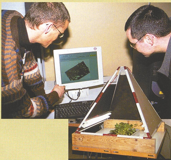
Versuchsanordnung: Mit einer hohen Trefferquote kann die spezielle Software auf Grund des Pflanzenmusters zwischen erwünschtem Pflanzenbewuchs und Blacken unterscheiden.
