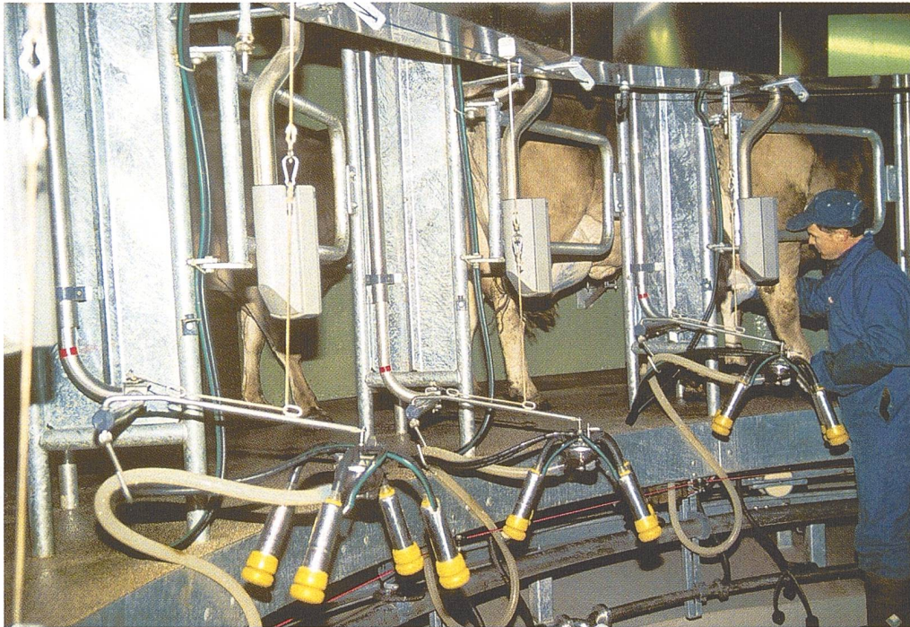
Nachdem Melkkarusselle wegen der Pannenanfälligkeit für längere Zeit in Vergessenheit geraten sind, feiern sie nun unter Verwendung von neuen Materialien bei Antrieb und Lagerung ein eigentliches Comeback. (Bild: Ueli Zweifel)
