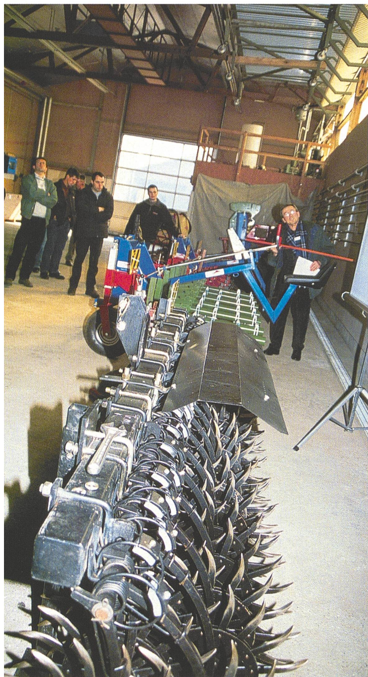
Grosse Vielfalt von Hackergeräten: im Vordergrund eine amerikanische Sternhacke für ein ganzflächiges Hacken. Die Sterne sind versetzt in zwei Querreihen angeordnet.
