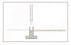
Abb. 8: Einzelfundament, bestehend aus einer Betonsohle und -säule. In der Säule lässt man eine Aussparung zur Verankerung der Binderstütze aus Holz. Nach Montage und Ausrichtung der Binder wird die Öffnung mit Beton ausgegossen.
