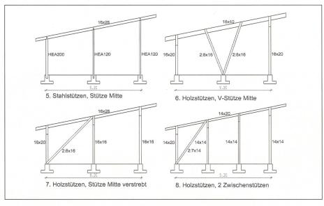
Abb. 6: Zwischenstützen machen die Binderkonstruktion schlanker, können jedoch störend für die Benutzung der Remise sein. Die Dimensionen beziehen sich auf einen Binderfeldabstand von 6 m und eine Bezugshöhe von 500 m ü.M. Die rechte Längsseite ist offen, die andere Längsseite sowie die Stirnseiten können offen oder geschlossen sein.
