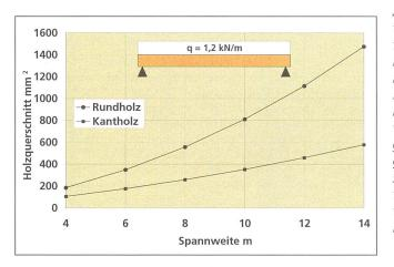
Abb. 1: Die ungünstige Querschnittform von Rundholz hat zur Folge, dass im Vergleich zu Kantholz vor allem bei grossen Spannweiten bedeutend grössere Holzmengen erforderlich sind. Grafik gültig für eine Streckenlast von 1,2 kN/m (120 kg pro Laufmeter).
