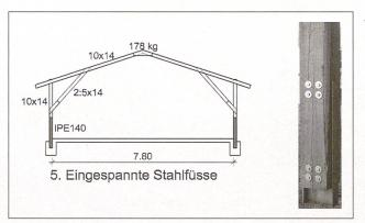
Abb. 4: Schlanker Dachbinder in verlängerten eingespannten Stahlfüssen (IPE) befestigt.
