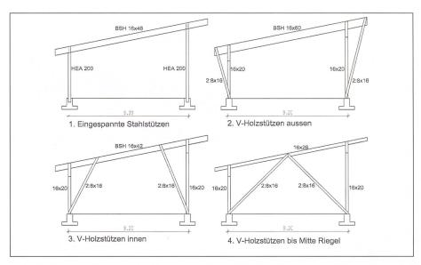
Abb. 5: Bindervarianten ohne Zwischenstützen für eine Remise. Die Dimensionen beziehen sich auf einen Binderfeldabstand von 6 m und eine Bezugshöhe von 500 m ü.M. Die rechte Längsseite ist offen, die anderen Seiten können offen oder geschlossen sein.
