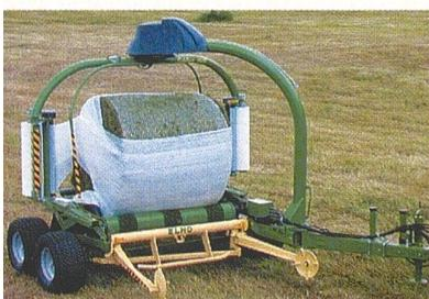
Bei den Modellen Sideliner 1520 und 1620 werden die Ballen in Fahrtrichtung der Presse aufgeladen und sanft auf der Tischmitte abgelegt. Der Wickeltisch besteht aus drei angetriebenen und mit Reibbelägen versehenen Walzen. Diese garantieren einen gleichmässigen Vorschub, auch bei unformigen Ballen. Der sehr niedere Wickeltisch in Verbindung mit einer exakten Ballenführung durch drei Walzen
