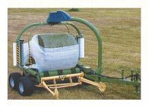
Bei den Modellen Sideliner 1520 und 1620 werden die Ballen in Fahrtrichtung der Presse aufgeladen und sanft auf der Tischmitte abgelegt. Der Wickeltisch besteht aus drei angetriebenen und mit Reibbelägen versehenen Walzen. Diese garantieren einen gleichmässigen Vorschub, auch bei unförmigen Ballen. Der sehr niedere Wickeltisch in Verbindung mit einer exakten Ballenführung durch drei Walzen
