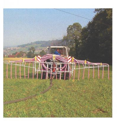
Beim Schleppschlauchverteiler wird die Gülle in Streifen direkt auf den Boden ausgebracht. Dadurch gelangt deutlich weniger NH₃ in die Luft.
