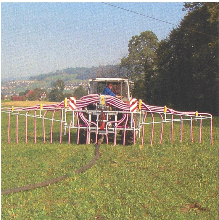
Beim Schleppschlauchverteiler wird die Gülle in Streifen direkt auf den Boden ausgebracht. Dadurch gelangt deutlich weniger \text{NH}_3 in die Luft.
