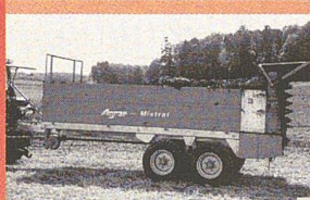
Miststreuer mit Tandem- achse 7-9 m 3
