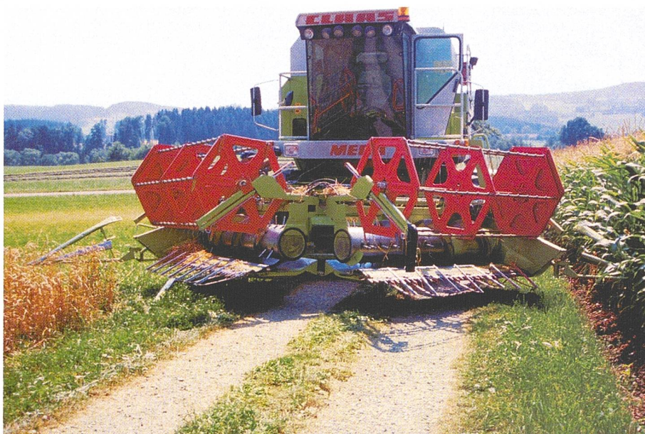
Abb. 18: Durch das hydraulisch einklappbare Schneidwerk beim Mähdrescher lässt sich insbesondere bei kleineren Parzellen der Rüstzeitenanteil reduzieren.
