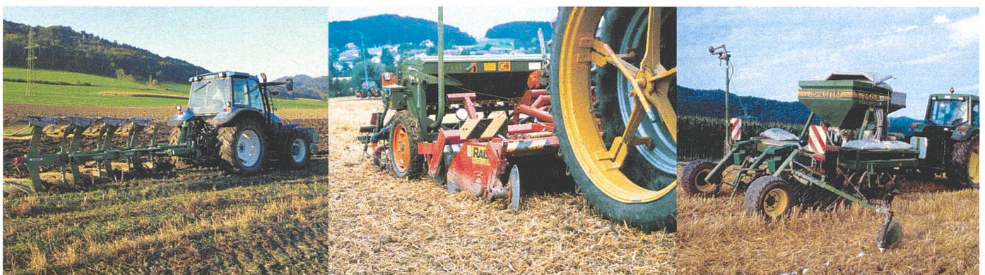
Abb. 1: Mit unterschiedlichen Verfahren zur Bodenbearbeitung und Saat (Pflug, Bestellkombination, Direktsaat) kann durch Verzicht auf Bearbeitungsgänge Arbeitszeit eingespart werden.
