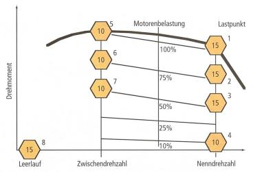
Im Rahmen der Typenprüfung oder einer Produktionsüberprüfung werden, je nach Fahrzeugkategorie, unterschiedliche Testreihen durchgeführt, damit die spezifischen Emissionen ermittelt werden können. Die Testreihe des bekannten 8-Stufen-Tests für Motoren von Arbeitsfahrzeugen, Traktoren und Motorkarren ist in der Grafik dargestellt. Dazu gehören die Grenzwerte in der Tabelle, die sich auf Traktoren und Motorkarren
