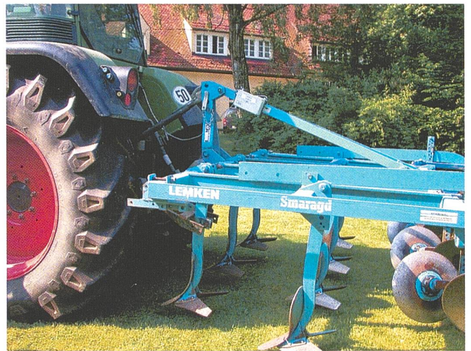
Hinter dem Oberlenker ist der geräteseitige IMI erkennbar (Geräteerkenner für Geräte ohne Jobrechner).
