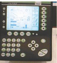
Basic-Terminal verschiedener Hersteller für die Steuerung von Anbaugeräten. Der Geräterechner versorgt das Terminal mit der entsprechenden Maske.
