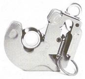
zwischen Traktor und Gerät begeben. Alle Kuppelvorgänge werden bequem, zeitsparend und sicher vom Traktorsitz aus ausgeführt. Bislang erforderten Verlegung und Umgang mit dem Seil, über das der Haken bedient wurde, besondere Sorgfalt. Der neue Haken kann sich niemals selbsttätig lösen.
