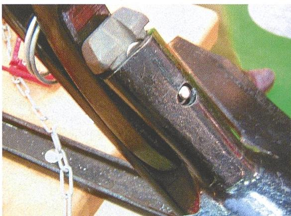
Ein Support auf dem Zinken erlaubt das Auswechseln von Verschleissteilen mit einem Handgriff.
