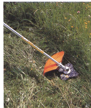
Grasschneideblatt, geeignet zum Mähen von zähem Gras und auf grossen Flächen.
