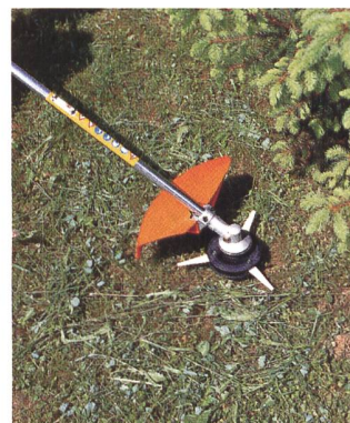
Mähkopfvariante mit drei beweglichen Kunststoffmessern für das Mähen von Grasflächen mittlerer Grösse und rund um Hindernisse.
