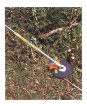
Kreissägeblatt für holziges Buschwerk und dünne Baumstämme.
