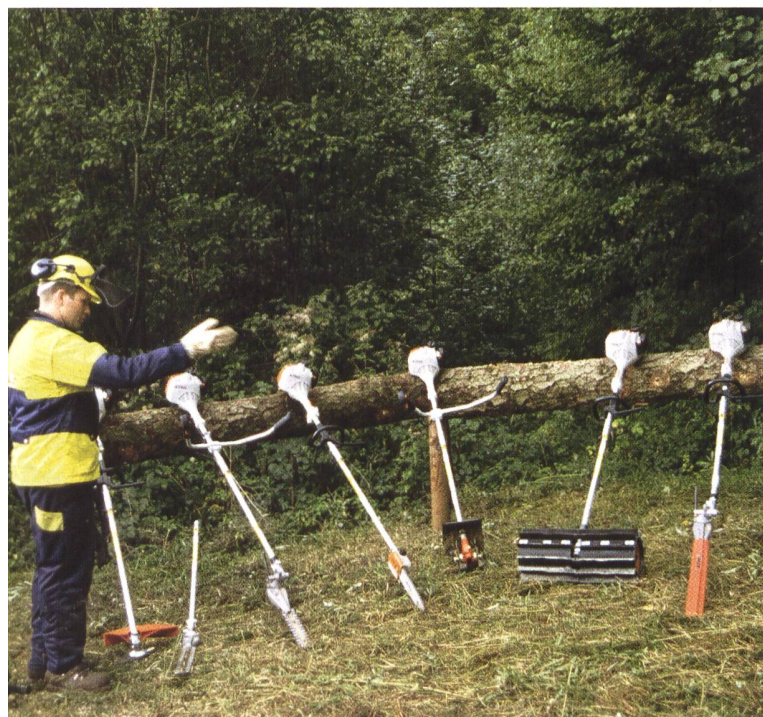
Mähkopf, vor allem geeignet für Mäharbeiten an Mauern, Zäunen und anderen Hindernissen.
