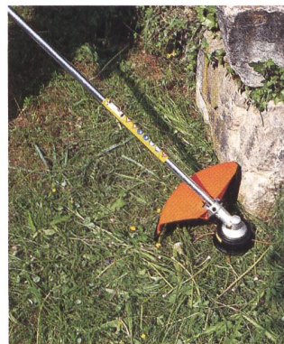
Mähkopf, vor allem geeignet für Mäharbeiten an Mauern, Zäunen und anderen Hindernissen.
