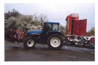
Modulartiger Aufbau: Mähwerkskombination Front- und Seitenmähwerk sowie Heckaufbereiter.
