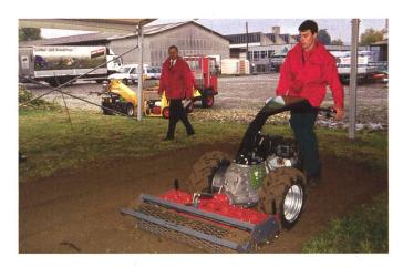
Der neue Motoreinachser mit hydrostatischem Fahrantrieb verfügt u. a. über eine «Rapid-Wendematikschaltung», sodass die Bedienfunktionen der Maschine, unabhängig von der Position der um 180 Grad drehbaren Holmen, beibehalten werden. Zwei unabhängige Fahrmotoren mit hydraulischen, progressiv arbeitenden Ventilen erleichtern die Manövrierbarkeit. (Bilder Ueli Zweifel)
