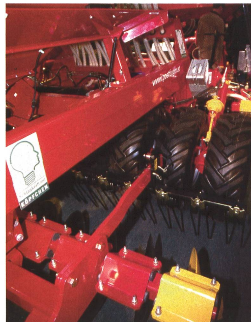
Reifenpacker: Fahrwerk und Anpressrollen zugleich (Pöttinger).
