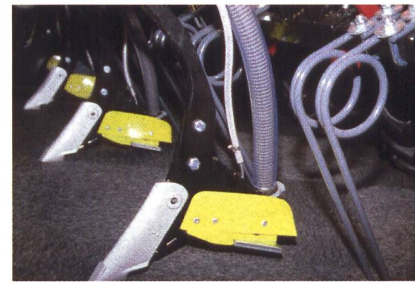
Meisselschar mit Gleitschuh aus Kunststoff: pneumatischer Säapparat mit Unterfussdüngung (Horsch).
