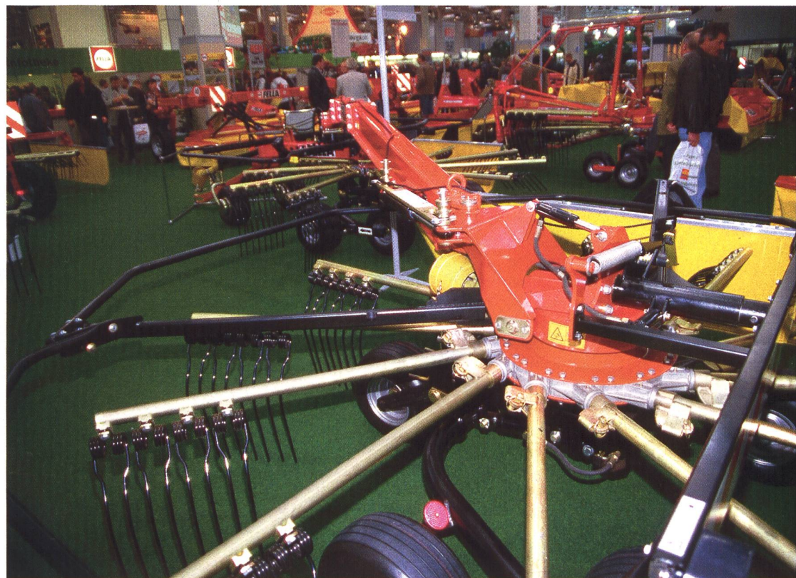
Enorme Flächenleistung: Grosskreiselschwader und -heuer für das Zugpendel am Traktor (Fella)
