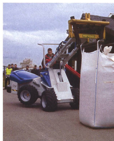
Das Kipprisiko beim Anheben von schweren Lasten ist sehr erheblich. Der Knicklenker CSF Jolly (Serie SL) verfügt über eine Sperre im Zentralrohr zur Stabilitäts-erhöhung des Fahrzeugchassis.
