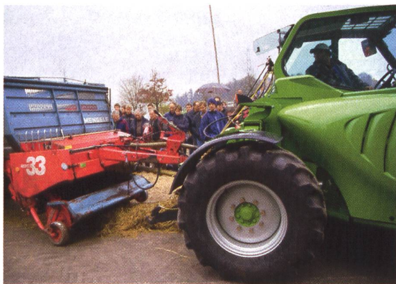
Merlo: Polyvalenz als Zugfahrzeug mit 3-Punkt-Hydraulik und Zapfwelle...
