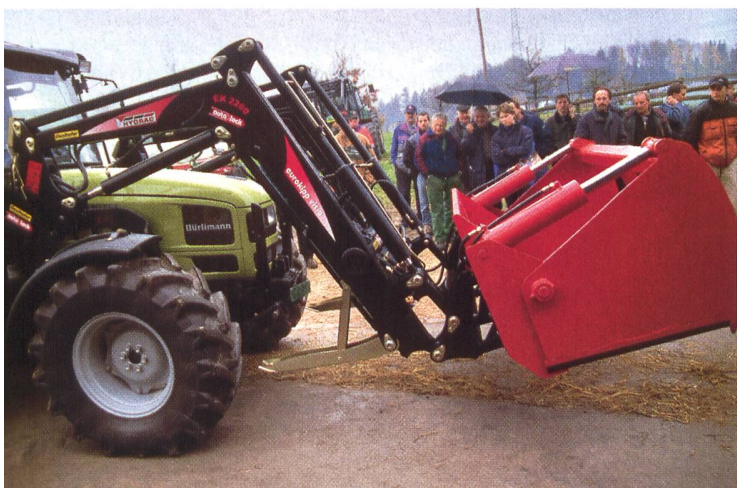
An- und Abkoppeln des Frontladers ohne abzusteigen.
