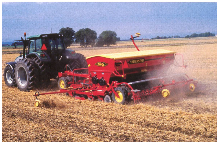
Väderstad: Rapid-Drillkombinationen sind so wendig, dass sie auf kleinen Parzellen sehr gut eingesetzt werden können. Alle Sääpparate sind auf Bodenbearbeitungsgeräte aufgesattelt und werden gezogen. Dadurch lässt sich der erforderliche Schardruck für die Mulch- und Direktsaat mühelos erreichen.
