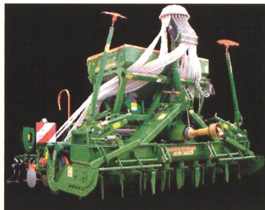
Amazone: Sämaschine für Pflugsaat und Bestellkombinationen mit Kreiselegge oder -grubber. Die Säorgane können mit WS-Schleppscharen oder RoTeC-Rollscharen für die Mulchsaat ausgerüstet werden.
