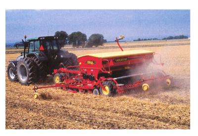
Väderstad: Rapid-Drillkombinationen sind so wendig, dass sie auf kleinen Parzellen sehr gut eingesetzt werden können. Alle Säapparate sind auf Bodenbearbeitungsgeräte aufgesattelt und werden gezogen. Dadurch lässt sich der erforderliche Schardruck für die Mulch- und Direktsaat mühelos erreichen.
