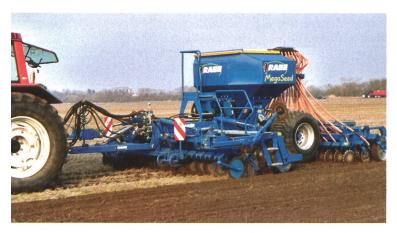
Rabe: Die MegaSeed ist eine Drillmaschine für Normal-, Mulch- und sogar Direktsaat. Arbeitswerkzeuge von der Traktorseite her: Mulchscheiben, Rückverfestigung (hinter dem Transportrad), Räumscheiben, Säaggregate, Andruckrollen, Striegel zum Einebnen.
