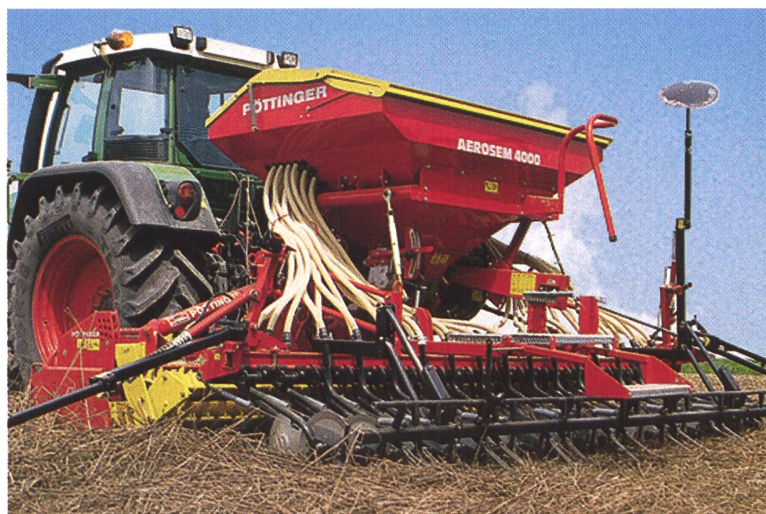
Pöttinger Aerosem 4000: Auf guten Standorten mit intensiver Bewirtschaftung bringen die hohen Getreideerträge auch eine hohe Strohmenge mit sich. Scheibenschare arbeiten weitgehend verstopfungsfrei.
