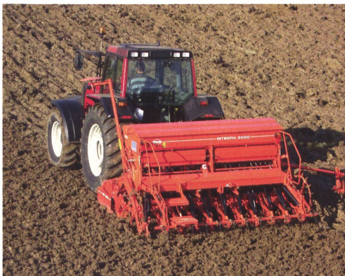
Kuhn-Integra: Aufbausämaschine Integra mit hydraulischer Scharaushebung und hydraulischer Schwerpunktsverlagerung gegen den Traktor während der Strassenfahrt. Für die meisten Sämaschinen gibt es leichte Scheibenschare, die eine problemlose Mulchsaat ermöglichen.
