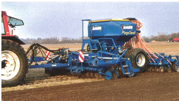
Rabe: Die MegaSeed ist eine Drillmaschine für Normal-, Mulch- und sogar Direktsaat. Arbeitswerkzeuge von der Traktorseite her: Mulchscheiben, Rückverfestigung (hinter dem Transportrad), Räumscheiben, Säaggregat, Andruckrollen, Striegel zum Einebnen.
