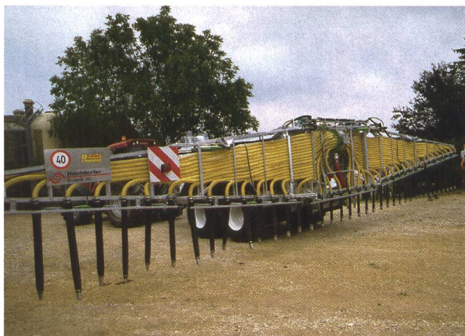
Die perfekte Signalisation kommt auch beim Ausbringen nicht in die Quere. Man beachte auch die Tropf-Stopp-Installation, bei der es je nach Hersteller unterschiedliche Lösungen gibt.
