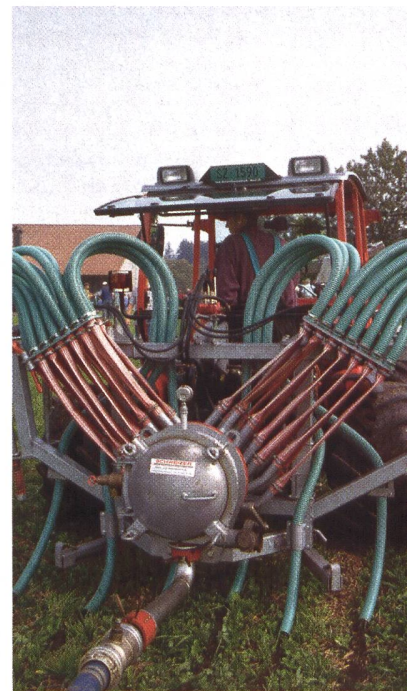
Die Zwangsbeschickung der Schleppschläuche sichert die gleichmässige Gülleausbringung auch im hängigen Gelände.
