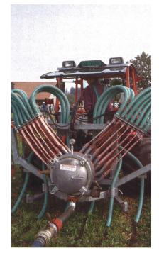
Die Zwangsbeschickung der Schleppschläuche sichert die gleichmässige Gülleausbringung auch im hängigen Gelände.
