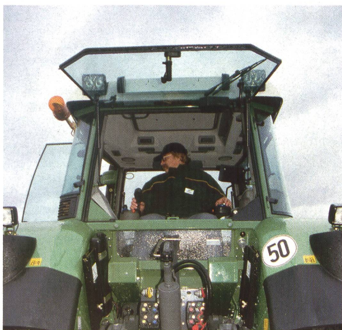
Voll integrierte Rückfahrvorrichtung: In der rechten Hand der Joystick, in der linken das Mini-Lenkrad.
