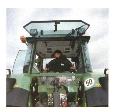
Voll integrierte Rückfahrvorrichtung: In der rechten Hand der Joystick, in der linken das Mini-Lenkrad.
