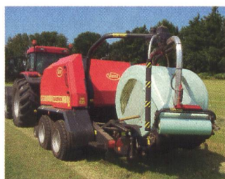
Vicon RV 160, variable Presskammer und progressive Verdichtung.
