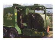
Krone Combi Pack 1500 V MC, variabel, mit Multicut-Schneidsystem.
