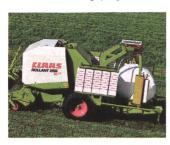
Claas Rollant Uniwrap verkürzter Arbeitsaufwand gegenüber separaten Verfahren.
