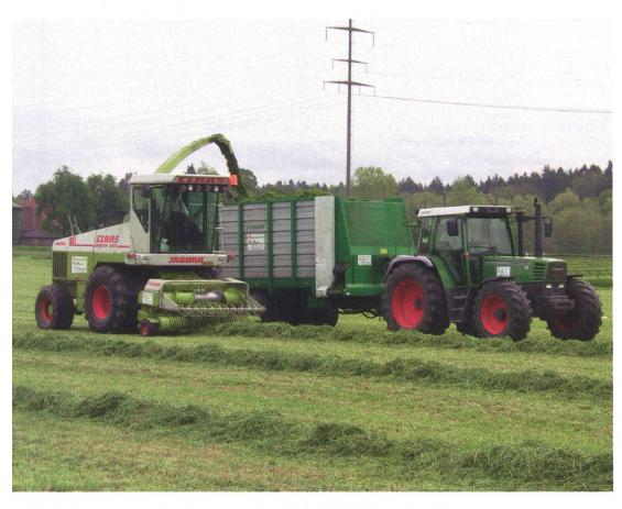
Beim Selbstfahrhäcksler muss die Mechanisierung vom Mähwerk bis zum Walzfahrzeug zusammenpassen, um eine hohe Flächenleistung erzielen zu können. (Bild: Matthias Schick, FAT)
