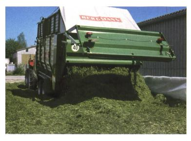
Moderne Grossraum-Silierladewagen mit Laderotor, Dosierentladung und Komfortbedienung sind auf den überbetrieblichen Einsatz ausgerichtet und erfordern eine hohe Auslastung (Bilder: Rainer Frick).
