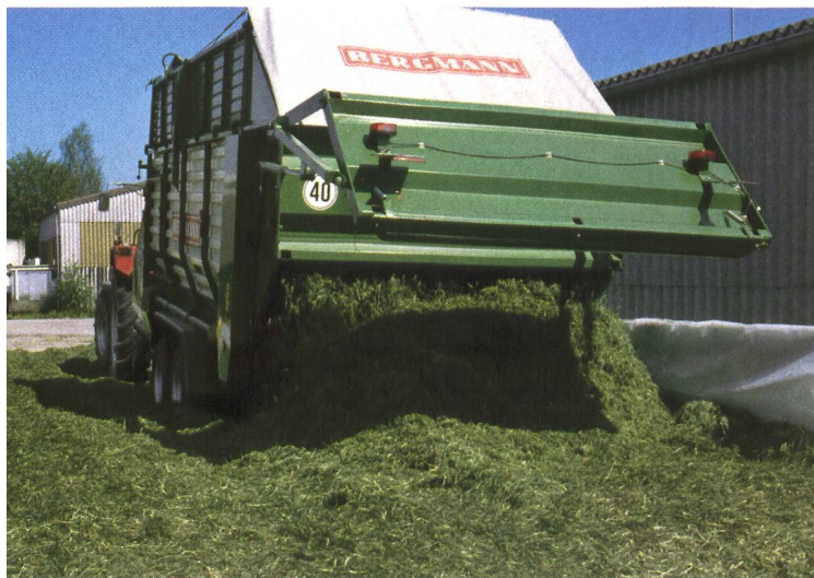
Moderne Grossraum-Silierladewagen mit Laderotor, Dosierentladung und Komfortbedienung sind auf den überbetrieblichen Einsatz ausgerichtet und erfordern eine hohe Auslastung (Bilder: Rainer Frick).
