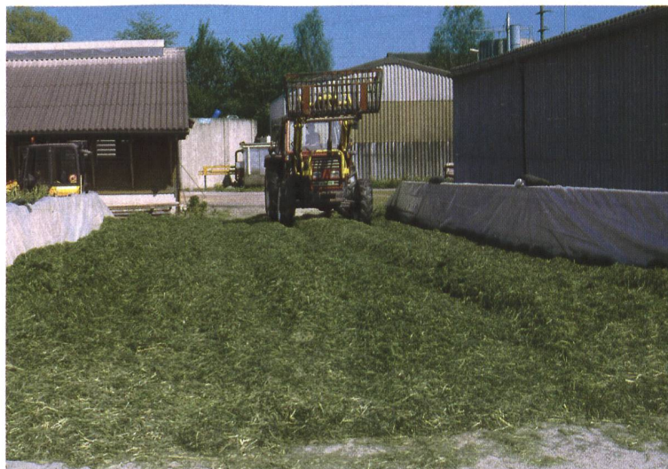
Eine möglichst gute Verdichtung ist beim Befüllen des Flachsilo ein absolutes Muss zur Erzeugung einer qualitativ guten Anweltsilage. Dazu braucht es ein geeignetes Walzfahrzeug und einen geübten Fahrer, der das Walzen sorgfältig und mit genügend Überfahrten durchführt.
