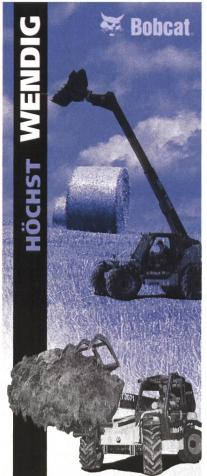
Mit den kompakten Bobcat-Teleskopen überwinden Sie auch Höhen auf kleinstem Raum. Der ideale Partner für den Landwirt, z.B. bei der Futterverteilung, der Handhabung von Siloballen, beim Ausmisten usw. Die Hubkräfte reichen bei den Modellen T 2556 / T 3071 von 2,5 bis 3,0 t; die max. Hubhöhen von 5,56 bis 7,05 m.
