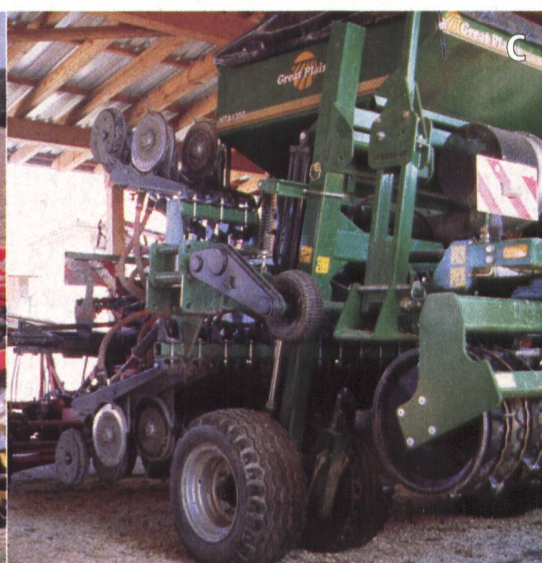
a) Tiefgrubber: Symptom- statt Ursachenbekämpfung; b) Einstellbare Scheibenegge Vario-Disc: Durchmischungswirkung durch variable Anstellwinkel der Scheiben und gezielte Rückverfestigung; c) Mulch- oder Direktsaat mit der Scheibensächar-Direktsaatmaschine; d) Einzelkornsäpparat für Mulcheinsaat von Mais und Zuckerrüben
