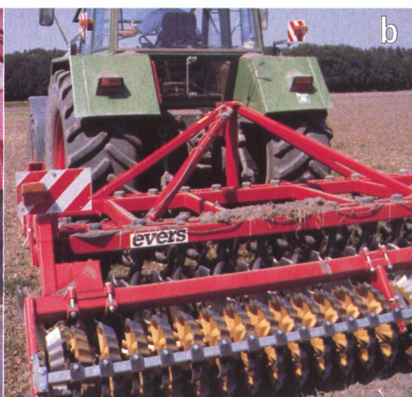
a) Tiefgrubber: Symptom- statt Ursachenbekämpfung; b) Einstellbare Scheibenegge Vario-Disc: Durchmischungswirkung durch variable Anstellwinkel der Scheiben und gezielte Rückverfestigung; c) Mulch- oder Direktsaat mit der Scheibensächar-Direktsaatmaschine; d) Einzelkornsäpparat für Mulcheinsaat von Mais und Zuckerrüben
